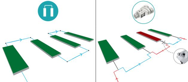
Câblage traversant en version KIT prêt à poser avec un connecteur à chaque extrémité, 3x1,5mm<sup>2</sup> (10A)
